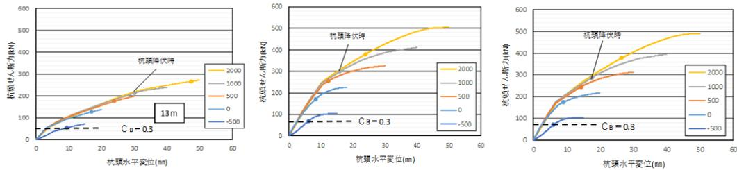
図3 単杭モデルにおける杭頭せん断力—杭頭水平変位の関係
